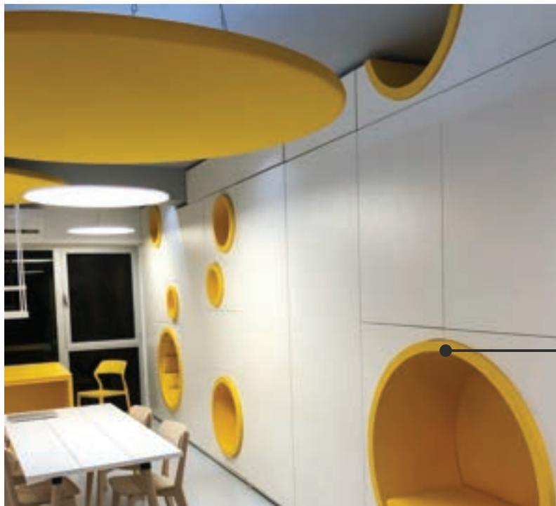
FABRICACIÓN DE MUEBLES DE COCINA EN MELAMINA BLANCO MATE CON NICHOS CIRCULARES EN ESTRUCTURA DE MADERA CON MDF LACADO.
